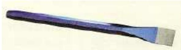
Son herramientas formadas por una punta de doble bisel. Se utilizan para tallar el material golpeando con un martillo sobre el mango con un ángulo de incidencia sobre el material de unos 5°.
